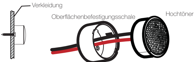
Abb. 4 Einbau auf der Oberfläche
