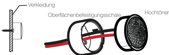
Abb. 4 Einbau auf der Oberfläche
