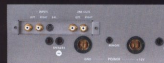
Riesige Kabelaufnahmen und symmetrische Eingänge prägen das Bild der Frontseite
