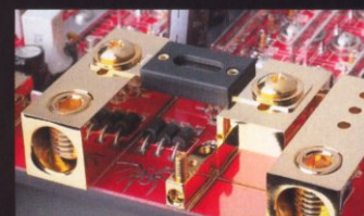
Die vergoldeten Stromanschlüsse nehmen Kabelquerschnitte bis zu 125 Quadratmillimeter auf
