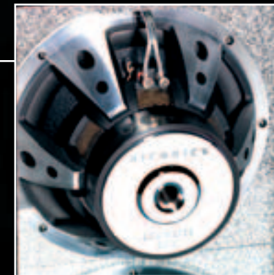
Airflow: Sechs Belüftungsfenster lassen Kühlluft an die Spule und dekomprimieren die Zentrierspinne.
