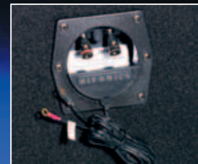
Anschluss: Jeder Woofer besitzt ein eigenes Push-Terminal, das 12-Volt-Kabel gehört zur LED-Beleuchtung.
