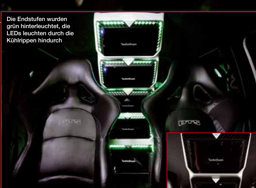
Die Endstufen wurden in einem Turm auf Basis eines geschweißten Stahlgerüsts angeordnet, der sich vom Boden bis zur Decke zieht.
