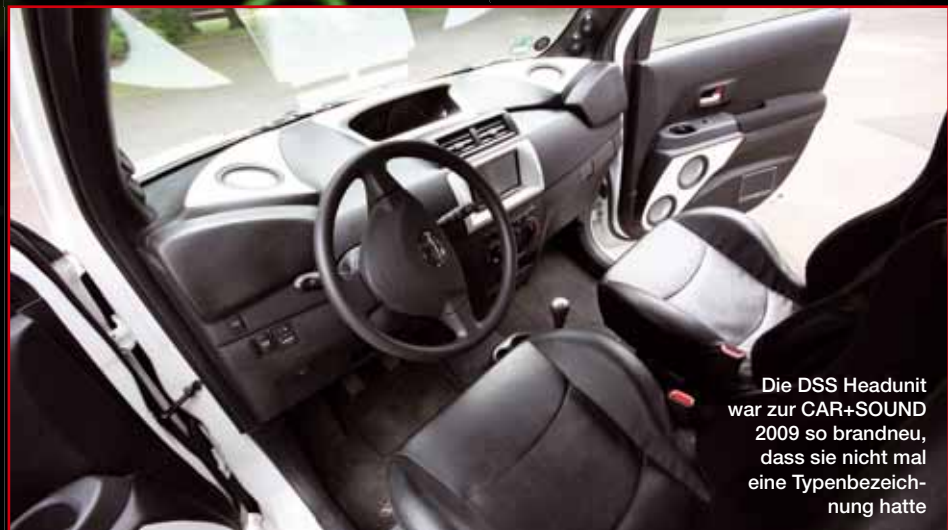
So wird ein Lautsprecher zum echten Hingucker: Erhöhte GFK-Ränder umschließen lackierte „Inlays“ für die Chassis
