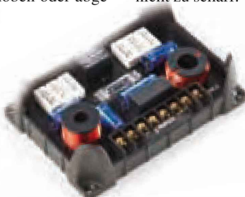
Es werde Licht: Die Weiche des RS 652 sichert den Tweeter per Glühlampe.
