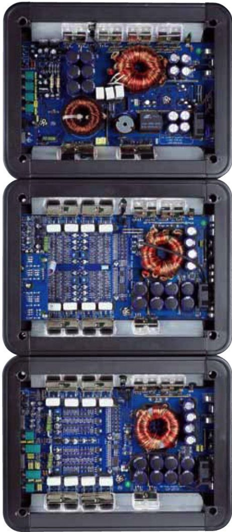
Platzsparende SMD-Bestückung bei den beiden „analogen“, die X-One ist ein Class-D-Verstärker
