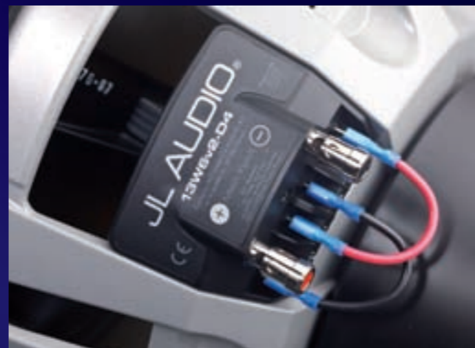
Steckspiel: Die beiden Schwingspulen können zu einer 8- oder 4-Ohm-Last zusammengeschaltet werden. Die Subwoofer-interne Verschaltung wird über Kabelbrücken-Jumper erledigt (links). Die Beschriftung der Anschlüsse und die gute Beschreibung im Datenblatt machen das alles kinderleicht (rechts).
