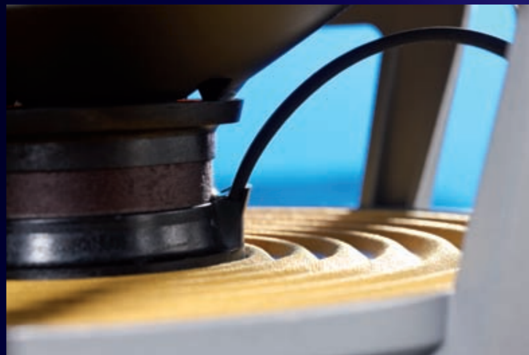
Hat den Bogen raus: Die vier Anschlusslitzen der beiden Schwingspulen werden in einer Art gummiertem Flachbandkabel zu den Anschluss terminals geleitet. Die Formgebung verhindert das Anschlagen und Überlasten bei großen Hüben.
