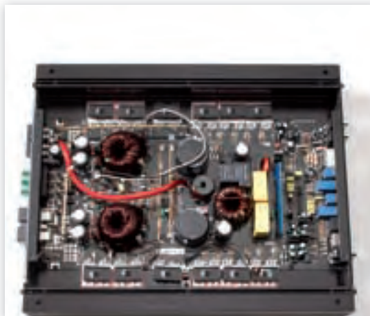
Hier fließt Strom: Die massiven Versorgungsleitungen und die dicken Leiterbahnen verdeutlichen die Power der B One.
