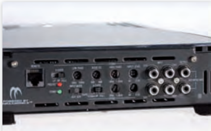
Innen und außen gut: Im Inneren der MB-Quart-Endstufe werkelt ein Doppeltrafo, die übrigen Bauteile auf der einfach kaschierten Platine sind ebenfalls von guter Qualität. Die Ausstattung liegt mit einer Dupe-Funktion, weiten Regelbereichen und einem Cinch-Ausgang auf gutem Niveau.
