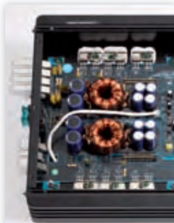
Innen und außen gut: Im Inneren der MB-Quart-Endstufe werkelt ein Doppeltrafo, die übrigen Bauteile auf der einfach kaschierten Platine sind ebenfalls von guter Qualität. Die Ausstattung liegt mit einer Dupe-Funktion, weiten Regelbereichen und einem Cinch-Ausgang auf gutem Niveau.
