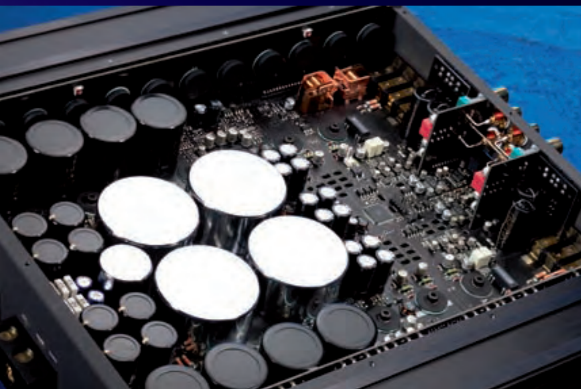
Einzigartig: Die verchromten Becher, in denen die Trafos und Spulen vergossen sind, sind echte Brax-Klassiker. Die neue Anordnung der Netzteil-Komponenten dient dazu, die Wege zu den Verbrauchern zu verkürzen und somit Verluste zu minimieren.
