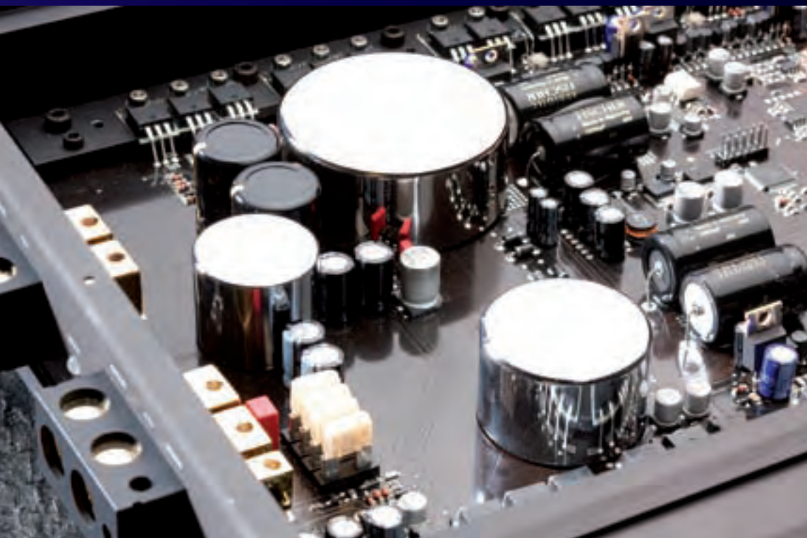
Glänzendes Trio: Die in verchromten Bechern vergossenen Trafos und Spulen sind ein Brax-Klassiker. Die Eingangs-Elkos werden in der Serienproduktion noch auf insgesamt sechs Stück und eine Kapazität von 30 000 Mikrofarad aufgestockt. Viel hilft eben viel – und sicher ist sicher.
