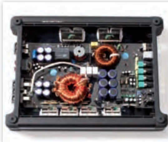
Klein, aber effektiv: Der Class-D-Schaltkreis der NSC 750 liefert an 1 Ohm mehr 800 Watt – das ist angesichts der Größe wirklich beachtlich.
