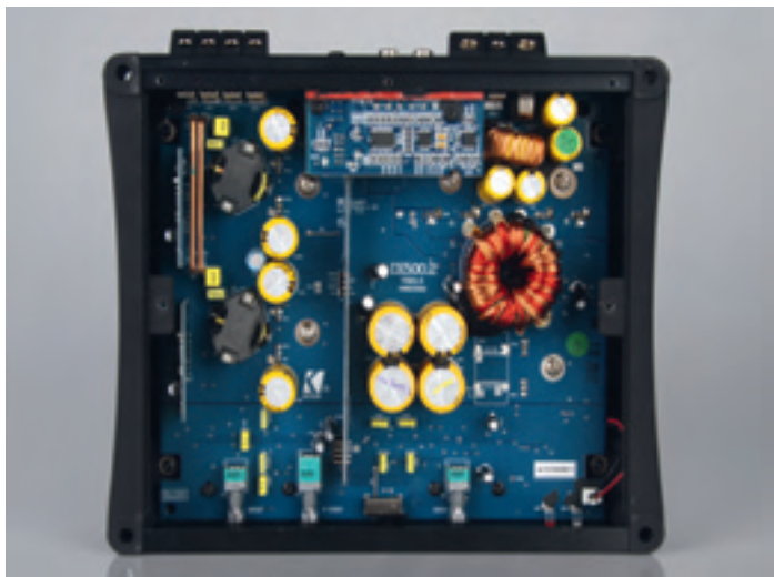
Class-D lässt grüßen: Das Netzteil rechts im Bild transformiert die Leistung auf ein Vielfaches der Bordnetzspannung, Spulen und Kondensatoren am Ausgang (linkes Bild Drittel) glätten das Signal.
