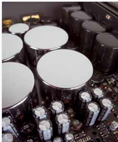
Die geschirmten Speicherdrosseln gleichen blitzschnell Schwankungen im Strombedarf aus
