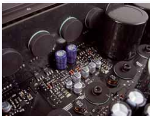
Die Endstufentreiber sind platzsparend in SMD-Bauweise realisiert
