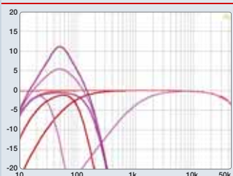
Hoch- und Tiefpass können zum Bandpass geschaltet werden
