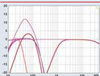
Der Vierkanäler bietet auf den Kanälen 3 und 4 die gleiche Ausstattung wie der Zweikanäler. Kanal 1 und 2 verzichten auf Tiefpass und Bass Boost
