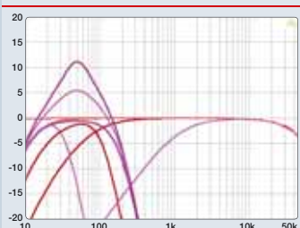
Hoch- und Tiefpass können zum Bandpass geschaltet werden
