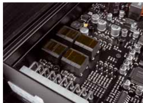
Die vier „Klötze“ sind die Spulen zur Rückgewinnung des Signals nach der Schaltverstärkung
