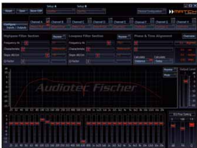
Das Hauptfenster der DSP-Software erlaubt die Einstellung der Frequenzweichen und des Equalizers
