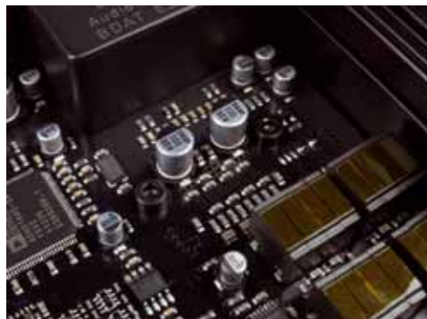
Im linken Bild ist der DSP-Chip von Analog Devices zu sehen. Rechts verraten die zwei schwarzen Inbusschrauben einen der beiden Verstärkerchips, der unter der Platine auf dem Kühlkörpergehäuse sitzt
