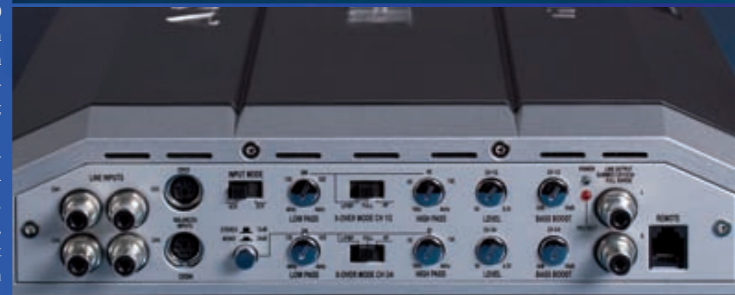
Schaltzentrale: Die Frequenzweiche der Boltar (oben) lässt kaum Wünsche offen, die Andromeda (unten) verfügt logischerweise über zwei Sektionen, eine eigene für jedes Stereopaar.
