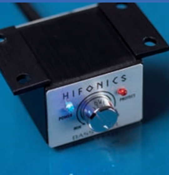
Steuermann: Die Boltar besitzt einen Fernbedienungs-Ausgang für weitere Endstufen, die dann dem gemeinsamen Basspegelregler synchron gehorchen.
