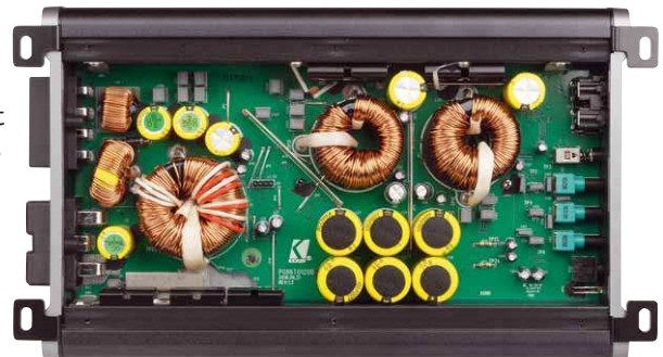
CXA400.1 (oben) und CXA800.1 (Mitte) haben das gleiche Layout, die 800.1 ist mit verstärkten Bauteilen ausgestattet
