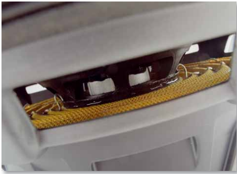
Die Woofer bieten eine geringe Einbautiefe, der Kunststoffspacer zwischen Spulenträger und Membran ist zur Belüftung des Innenraums gelocht
